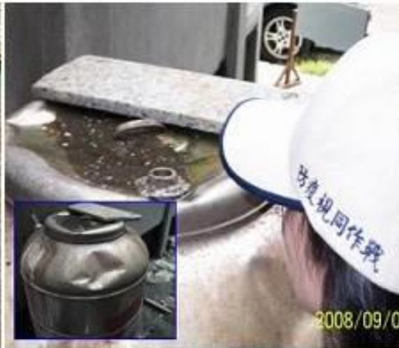
儲水桶鐵蓋凹陷處
